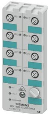
Module compact K60 AS-i TOR 4DI/4DQ IP67 4 x entrées, 200 mA max. 4 x sorties, 2A, 24V CC 4 A max. pour toutes les sorties 8 x connecteurs femelle M12 Plaque de montage 3RK1901-0CA00 à commander séparément
