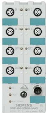
Module compact K60 AS-i TOR 4DI/4DQ IP68 4 x entrées, 200 mA max. 4 x sorties, 2A, 24V CC 4 A max. pour toutes les sorties 8 x connecteurs femelle M12 Plaque de montage 3RK1901-0CA00 à commander séparément
