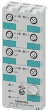
Module compact K60 AS-i TOR 4DI/4DQ IP67 4 x entrées, 200 mA max. 4 x sorties, 2A, 24V CC 4 A max. pour toutes les sorties 8 x connecteurs femelle M12 avec brochage Y-II Plaque de montage 3RK1901-0CA00 à commander séparément
