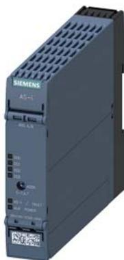
Module AS-i SlimLine Compact SC22.5 numérique, esclave A/B 4DQ, IP20 4 x sorties, 2A, 24V CC 4 A max. pour toutes les sorties bornes à ressort largeur 22,5mm
