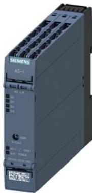
Module AS-i SlimLine Compact SC22.5 numérique, esclave A/B 4DI, IP20 4 x entrées pour capteur à 3 fils alimentation capteur commutable bornes à vis largeur 22,5mm
