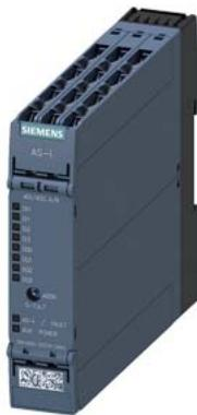
Module AS-i SlimLine Compact SC22.5 numérique, esclave A/B 4DI/4DQ IP20 4 x entrées pour capteur à 3 fils alimentation capteur commutable 4 x sorties, 2A, 24V CC 4 A max. pour toutes les sorties bornes à vis largeur 22,5mm
