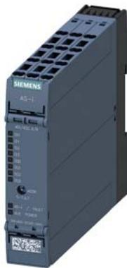
Module AS-i SlimLine Compact SC22.5 numérique, esclave A/B 4DI/4DQ IP20 4 x entrées pour capteur à 3 fils alimentation capteur commutable 4 x sorties, 2A, 24V CC 4 A max. pour toutes les sorties bornes à ressort largeur 22,5mm
