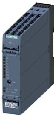
Module AS-i SlimLine Compact SC22.5 numérique, esclave A/B 4DI/4RQ, IP20 4 x entrées pour capteur à 3 fils alimentation capteur commutable 4 x relais de sortie 1 A 24V CC bornes à vis largeur 22,5mm
