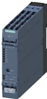
Module AS-i SlimLine Compact SC22.5 numérique, esclave A/B 4DI/2RQ, IP20 4 x entrées pour capteur à 3 fils alimentation capteur commutable 2 x relais de sortie 1 A 24V CC bornes à vis largeur 22,5mm
