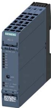
Module AS-i SlimLine Compact SC22.5 numérique, esclave A/B 4DI/2RQ, IP20 4 x entrées pour capteur à 3 fils alimentation capteur commutable 2 x relais de sortie 1 A 24V CC bornes à ressort largeur 22,5mm
