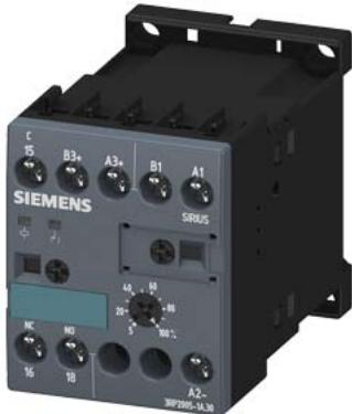
Relais temporisé, électronique multifonction, 8 fonctions 1 contact inverseur 24 V CA/CC, 200 à 240 V CA pour 50/60 Hz CA 0,05 s à 100 h Largeur 45 mm Borne à vis
