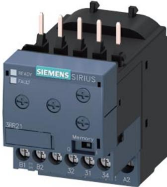
Relais de surveillance, pouvant être monté sur contacteur 3RT2, taille S00 Basic, à réglage analogique surveillance de courant apparent 1,6-16 A, 20-400 Hz, biphasé Alimentation 24-240 V CA/CC 1 contact inverseur Surveillance de dépassement haut/bas du courant Perte de phase, rupture de fil avec ou sans mémoire défaut Temporisation au démarrage 0-60 s Suppression des pointes de perturbation 0-30 s Hystérésis de commutation 6 % Connectique par bornes à vis
