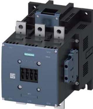
contacteur de puissance, AC-3e/AC-3 400 A, 200 kW / 400 V AC (50-60 Hz) / DC Uc : 110-127 V 3 pôles, contacts auxiliaires 2 NO + 2 NF entraînement : conventionnel courant principal: barre circuit de commande et de courant aux. : borne à vis
