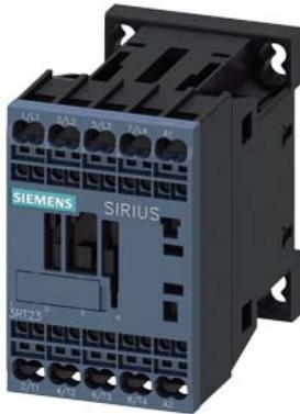
contacteur AC-1, 18 A, 400 V / 40 °C, 4 pôles, AC 24 V, 50/60 Hz, borne à ressort, taille : S00
