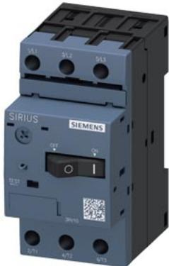
Disjoncteur de taille S00 pour la protection des moteurs, CLASS 10 Déclencheur de surcharge à temps dépendant 0,11...0,16 A Déclencheur de court-circuit 2,1 A Borne à vis pouvoir de coupure standard
