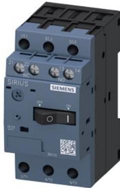
Disjoncteur de taille S00 pour la protection des moteurs, CLASS 10 Déclencheur de surcharge à temps dépendant 1,4...2 A Déclencheur de court-circuit 26 A Borne à vis pouvoir de coupure standard avec interrupteur auxiliaire transversal 1 contact à fermeture+1 contact à ouverture,
