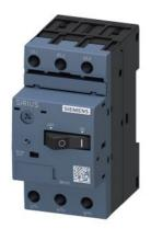
Disjoncteur de taille S00 pour la protection des moteurs, CLASS 10 Déclencheur de surcharge à temps dépendant 5,5...8 A Déclencheur de court-circuit 104 A Borne à vis pouvoir de coupure standard
