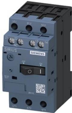
Disjoncteur de taille S00 pour la protection des moteurs, CLASS 10 Déclencheur de surcharge à temps dépendant 5,5...8 A Déclencheur de court-circuit 104 A 1 NO +1 NF transversal Borne à vis pouvoir de coupe standard
