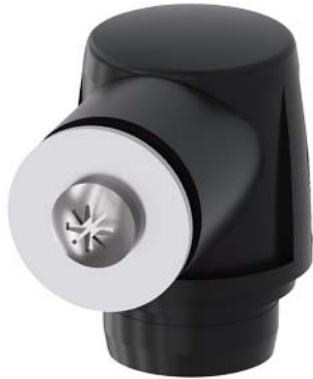
Tête de commande à levier à galet pivotant (levier à commander séparément) pour interrupteur de position 3SE52/3SF12 pour 31/50 mm, Points de commutation selon EN 50047. Le sens de commutation du levier est réglable sur gauche/droite ou seulement gauche ou seulement droite. État à la livraison: gauche/droite
