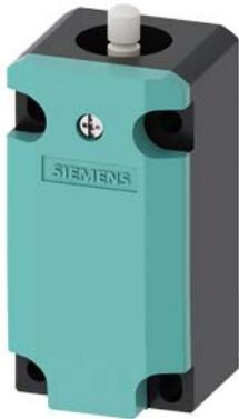
Interrupteur de base pour interrupteur de position 3SE51 Boîtier métallique, selon EN 50041 1x (M20x 1,5) Contacts à action dépendante 1 NO / 1 NO sans tête de commande
