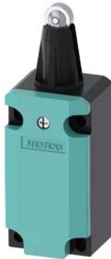
Interrupteur de position Boîtier métallique, 40 mm selon EN 50041 Raccordement d'appareil 1 x (M20 x 1,5) Contacts à action dépendante 1 NO / 1 NO Poussoir à galet avec galet en acier inoxydable 13 mm
