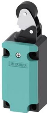
Interrupteur de position Boîtier métallique, 40 mm selon EN 50041 Raccordement d'appareil 1 x (M20 x 1,5) contacts à action brusque 1 NO / 1 NF Levier à galet, Levier métallique et galet en plastique, 22 mm
