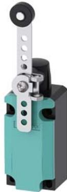
Interrupteur de position Boîtier métallique, 40 mm selon EN 50041 Raccordement d'appareil 1 x (M20 x 1,5) contacts à action brusque 1 NO / 1 NF Servomoteur à fraction de tour réglable à droite/à gauche avec levier métallique réglable en longueur de 100 mm de long et avec arrêtage (rangée de trous) et galet plastique, 19 mm
