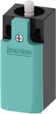
interrupteur de position boîtier en matière plastique selon EN 50047, 31 mm, raccordement d'appareil 1 x(M20 x 1,5), contacts à action dépendante 1 NO / 1 NF, poussoir à calotte sphérique, forme B
