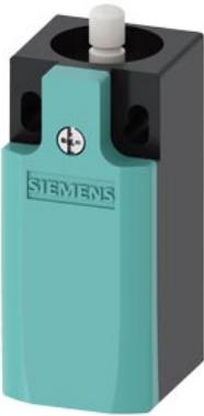
interrupteur de position boîtier plastique selon EN 50047, 31 mm raccordement d'appareil 1 x (M20 x 1,5) contacts à action brusque 1 NO / 1 NF intégrés (non remplaçables) poussoir à calotte sphérique forme B
