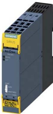
Bloc logique de sécurité SIRIUS Série d'appareils de base standard Circuits de validation à relais 3 contacts NO plus circuit de signalisation à relais, 1 contact NF
