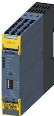
Bloc logique de sécurité SIRIUS Série d'appareils de base Advanced avec temporisation 0,05-3 s Circuits de validation à relais 2 NO instantané 2 NO temporisé Us = 24 V DC borne à vis
