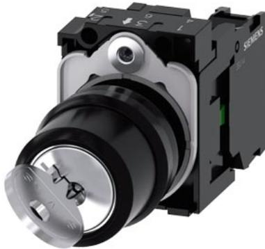
Commutateur à clé RONIS, 22 mm, rond, plastique, N° de serrure SB30 avec 2 clés, 2 positions de commutation O-I, à accrochage, 10:30h/13:30 h, Retrait de la clé O+I, avec support, 1S, borne à vis, serrures spéciales : SB31, 421, 455
