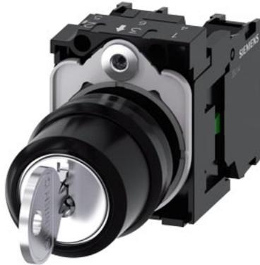
Commutateur à clé RONIS, 22 mm, rond, plastique, N° de serrure SB30 avec 2 clés, 3 positions de commutation I-O-II, à accrochage, 10:30h/12h/13:30 h, Retrait de la clé I+O+II, avec support, 1S, 1S, borne à vis, serrures spéciales : SB31, 421, 455
