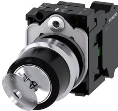
Commutateur à clé RONIS, 22 mm, rond, métal, brillant, N° de serrure SB30 avec 2 clés, 2 positions de commutation O-I, à accrochage, angle de manœuvre 90°, 10:30h/13:30 h, retrait de la clé O+I, avec support, 1 NF, borne à ressort, serrures spéciales : SB31, 421, 455
