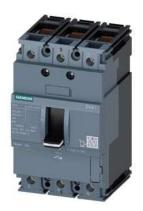
Disjoncteur 3VA1 CEI cadre 160 classe de coupure S Icu=36kA à 415V 3 pôles, protection des installations TM210, FTFM, In=100A protection contre les surcharges Ir=100A réglage fixe protection contre les courts-circuits Ii=10 x In raccordement par bornes
