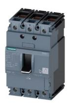
Disjoncteur 3VA1 CEI cadre 160 classe de coupure S Icu=36kA à 415V 3 pôles, protection des installations TM210, FTFM, In=125A protection contre les surcharges Ir=125A réglage fixe protection contre les courts-circuits Ii=10 x In raccordement par bornes
