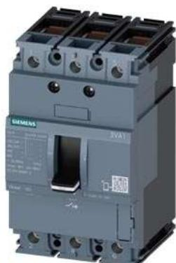
Disjoncteur 3VA1 CEI cadre 160 classe de coupure S Icu=36kA à 415V 3 pôles, protection des installations TM210, FTFM, In=160A protection contre les surcharges Ir=160A à réglage fixe protection contre les courts-circuits li=10 x In raccordement par bornes
