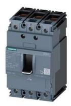
Disjoncteur 3VA1 CEI cadre 160 classe de coupure S Icu=36kA à 415V 3 pôles, protection des installations TM210, FTFM, In=50A protection contre les surcharges Ir=50A réglage fixe protection contre les courts-circuits li=10 x In raccordement par bornes
