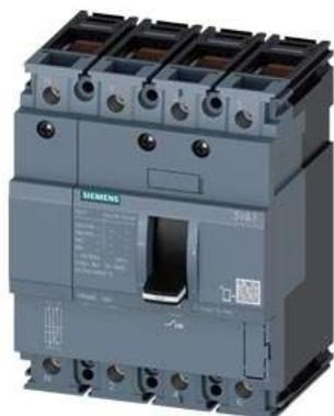
Disjoncteur 3VA1 CEI cadre 160 classe de coupure S Icu=36kA @ 415V 4 pôles, protection des installations TM210, FTFM, In=50A protection contre les surcharges Ir=50A réglage fixe protection contre les courts-circuits li=10 x In conducteur neutre non protégé raccordement par bornes
