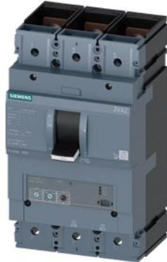
Disjoncteur 3VA2 CEI Frame 400 classe de coupure C Icu=110kA à 415V 3 pôles, protection de moteur ETU350M, LSI, In=250A protection contre les surcharges Ir=100A...250A protection contre les courts-circuits I<sub>sd</sub>=3...15 x I<sub>r</sub>, I<sub>i</sub>=15 x I<sub>n</sub> plage de raccordement par vis
