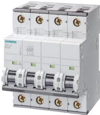
Disjoncteur modulaire 400V 25kA, 4 pôles, 10A, T=70mm uniquement déclenchement magnétique
