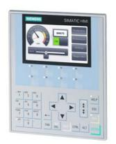
SIMATIC HMI KP400 Comfort, Comfort Panel, commande par touches, écran TFT large 4", 16 millions de couleurs, interface PROFINET, interface MPI/PROFIBUS DP, 4Mo de mémoire de configuration, Windows CE 6.0, configurable à partir de WinCC Comfort V11
