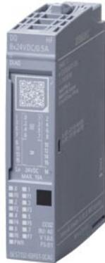
SIMATIC ET 200SP, module de sortie TOR, DQ 8x24 V CC/0,5 A High Feature, sortie de source (PNP, de type P), colisage : 1 pièce, convient pour BU de type A0, code de couleur CC02, diagnostic de voie pour : protection contre les courts-circuits et rupture de fil, tension d'alimentation, LED défaut de voie
