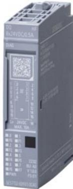
SIMATIC ET 200SP, module de sortie TOR, DQ 8x24 V CC/0,5 A High Feature, sortie de source (PNP, de type P), colisage : 1 pièce, convient pour BU de type A0, code de couleur CC02, diagnostic de voie pour : protection contre les courts-circuits et rupture de fil, tension d'alimentation, LED défaut de voie
