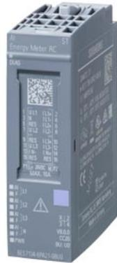
SIMATIC ET 200SP, module d'entrées analogiques, compteur énergétique RC ST, pour bobines Rogowski ou transformateur de courant/tension 333 mV, convient pour BU de type U0, diagnostic de voie
