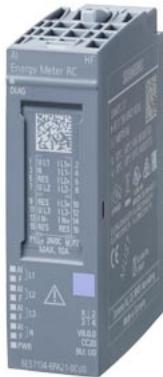
SIMATIC ET 200SP, module d'entrées analogiques, compteur énergétique RC HF, pour bobines Rogowski ou transformateur de courant/tension 333 mV, avec fonctions d'analyse du réseau, convient pour BU de type U0, diagnostic de voie
