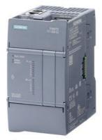
SIMATIC S7-1200 G2 : CPU compacte 1212C DC/DC/DC ; alimentation : DC 20,4-28,8V DC ; E/S intégrée : 8x DI 24V DC ; 6x DO 24V DC ; mémoire : programme 150 Ko données : 500 Ko, rémanence : 20 Ko
