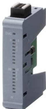
SIMATIC S7-1200 G2 : module d'entrées/sorties TOR SB 1223, 4DI/4DO 100 kHz ; entrées : 4 x DI 24 V CC Sink/Source, 100 kHz ; sorties : 4 x DQ 24 V DC 0,1 A puits/source transistor, 100 kHz
