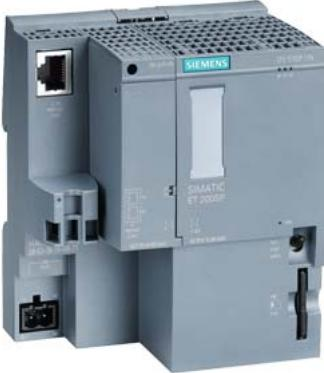
\*\*\* pièce de rechange \*\*\* SIMATIC DP, CPU 1510SP-1 PN pour ET 200SP, module unité centrale avec 100 Ko de mémoire de travail pour le programme et 750Ko pour les données, 1ère interface : PROFINET IRT avec commutateur 3 ports, performance sur bit 72 NS, SIMATIC Memory Card nécessaire, adaptateur de bus nécessaire pour port 1 et 2
