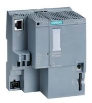
SIMATIC DP, CPU 1512SP-1 PN pour ET 200SP, Module unité centrale avec 200 Ko de mémoire de travail pour le programme et 1 Mo pour les données, 1. interface : PROFINET IRT avec commutateur 3 ports, performance sur bit 48 NS, carte mémoire SIMATIC nécessaire, adaptateur de bus nécessaire pour port 1 et 2
