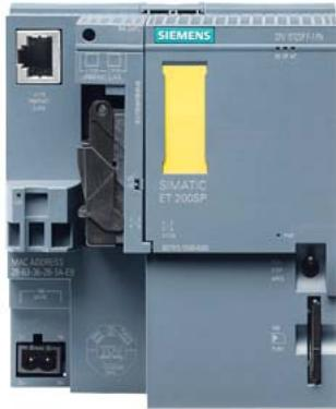
\*\*\* pièce de rechange \*\*\* SIMATIC DP, CPU 1512SP F-1 PN pour ET 200SP, module unité centrale avec 300 Ko de mémoire de travail pour le programme et 1 Mo pour les données, 1ère interface : PROFINET IRT avec commutateur 3 ports, performance sur bit 48 NS, SIMATIC Memory Card nécessaire, adaptateur de bus nécessaire pour port 1 et 2
