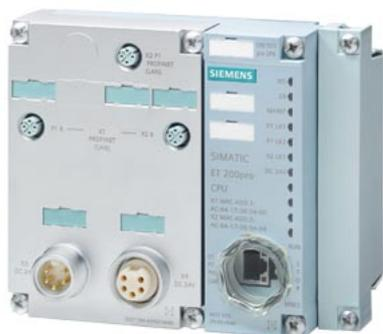
SIMATIC DP, CPU 1513pro-2 PN pour ET 200pro, unité centrale avec 300 Ko de mémoire de travail pour le programme et 1,5 Mo pour les données, 1ère interface : PROFINET IRT avec commutateur 3 ports, 2ème interface: PROFINET RT, performance sur bit 40 NS, indice de protection : IP65/67, carte mémoire SIMATIC nécessaire module de connexion nécessaire
