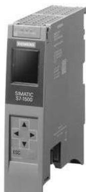
SIMATIC S7-1500, CPU 1513-1 PN, module unité centrale avec 600 Ko de mémoire de travail pour le programme et 2,5 Mo pour les données, 1ère interface : PROFINET IRT avec commutateur 2 ports, performance sur bit 25 ns, SIMATIC Memory Card nécessaire \*\*\*\* respecter les homologations et le certificat conformément à la contribution 109815653 sur support.industry.siemens.com ! \*\*\*\*
