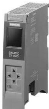
SIMATIC S7-1500R, CPU 1513R-1PN, module unité centrale avec 600 Ko de mémoire de travail pour le programme et 2,5 Mo pour les données, 1ère interface : PROFINET RT, avec commutateur 2 ports, SIMATIC Memory Card nécessaire \*\*\*\* respecter les homologations et le certificat conformément à la contribution 109815625 sur support.industry.siemens.com ! \*\*\*\*
